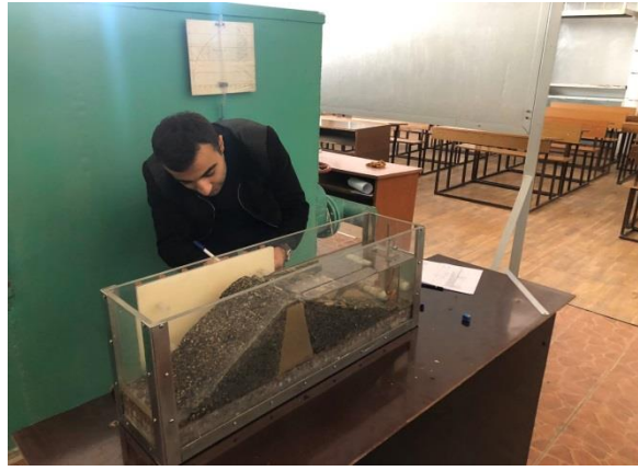
ա) Քարալիցքային միջուկով պատվարի լաբորատոր կառուցված մոդել բ- տեսքը չափիչ սարքի կողմից բ- տեսքը պատվարի կողմից
