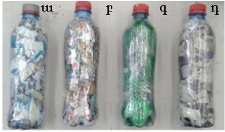
Նկ. 2. Էկո-աղյուսի հումքի նախնական արտաքին տեսքը, ա - տեսրապակով լցված շիշ, բ - մետաղով լցված շիշ, գ - պոլիէթիլենային տեֆալատ, դ - թուղթ, սովարաթուղթ
