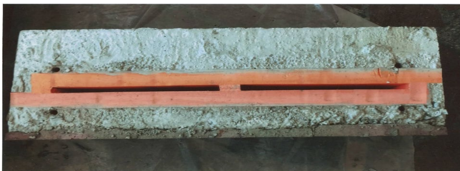
Նկ. 2. Եռաշերտ պատ փրփրապլեկա ջերմամեկուսիչ սալերի տեղաշարժամբ
